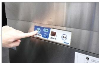
④ 扉を閉め、電源ボタンを押してください。洗浄可能ランプが点滅し、洗浄タンクへの給湯運転を開始します。
