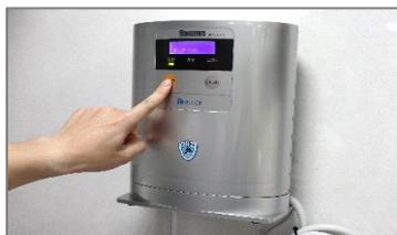
③ 本体前面にあるポンプのボタンを押し、水栓に取り付けてある混合器から食塩水が出てきたら再度ポンプボタンを押して停止します。
