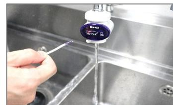
④ 水栓を開けてから付属の試験紙で次亜水が生成されているかを確認し使用してください。
