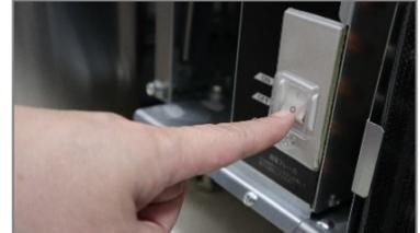
④下降後、漏電ブレーカーをOFFにして電源プラグを抜き、扉を解放して、庫内を乾燥させてください。
